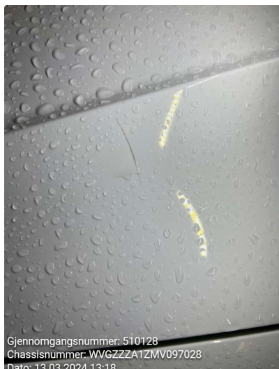
1.1 Ripe(r) ned til grunning
