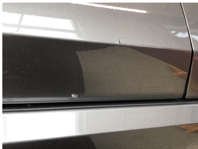
2.2 Ripe ned til grunning
