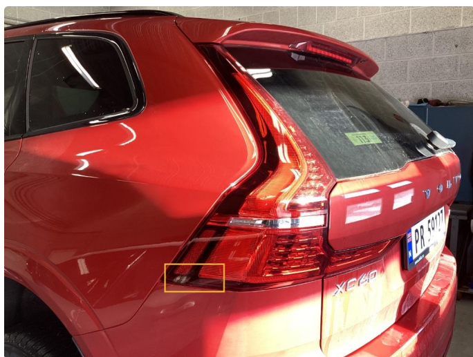
3.1 Krakelering i plast. Byttet
