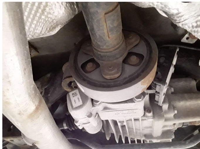
3.1 Medbringerflens på mellomaksel sitter fast. Kan skape noe vibrasjoner.
