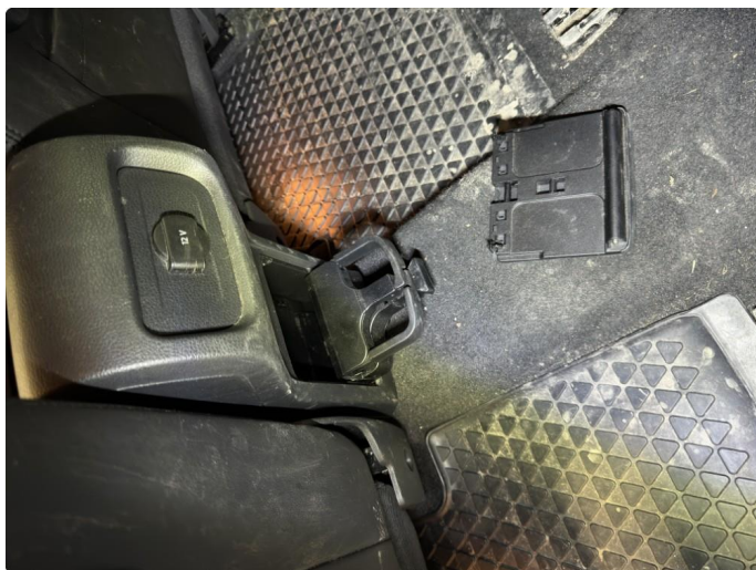
2.1 Koppholder bak er ødelagt
