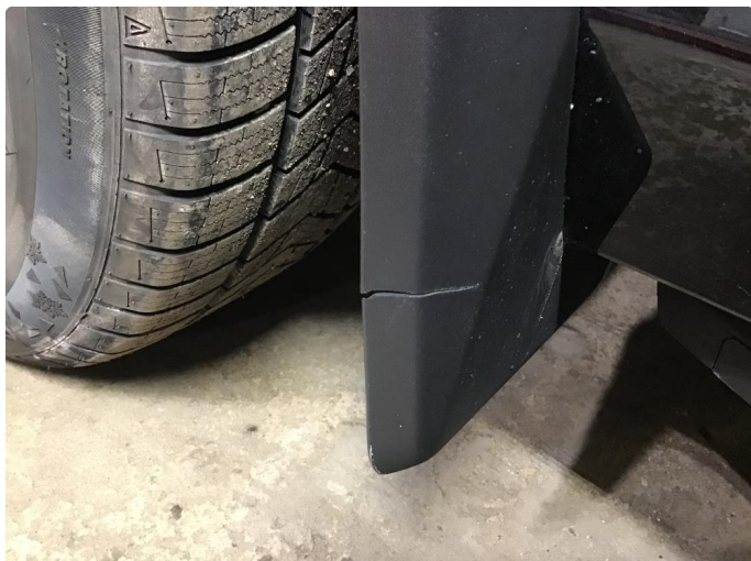
1.1 Lite sprekk i skvettlapp venstre foran
