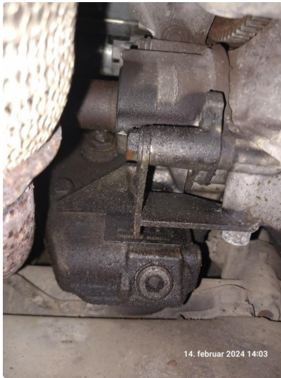
4.2 Svetting fra drivakselmansjett. Skiftet mars 2024
