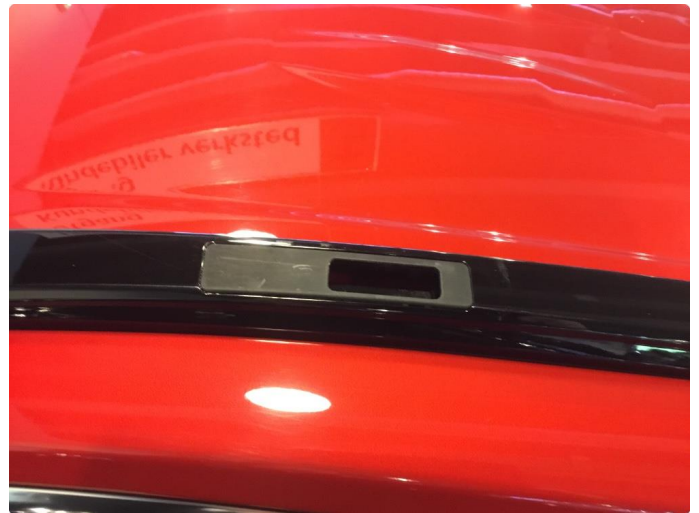
1.1 Deksler på tak/rails mangler
