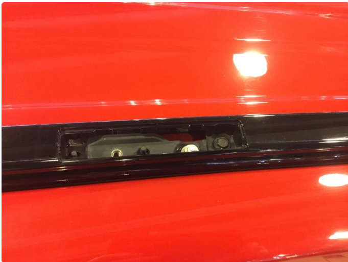
1.1 Deksler på tak/rails mangler
