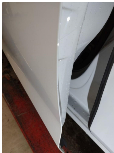
1.2 Ripe ned til grunning
