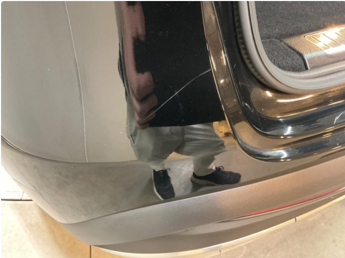
1.3 Ripe(r) ned til grunning
