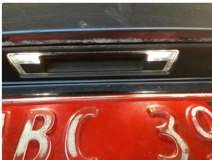
2.1 Defekt / sprukket glass. Byttet
