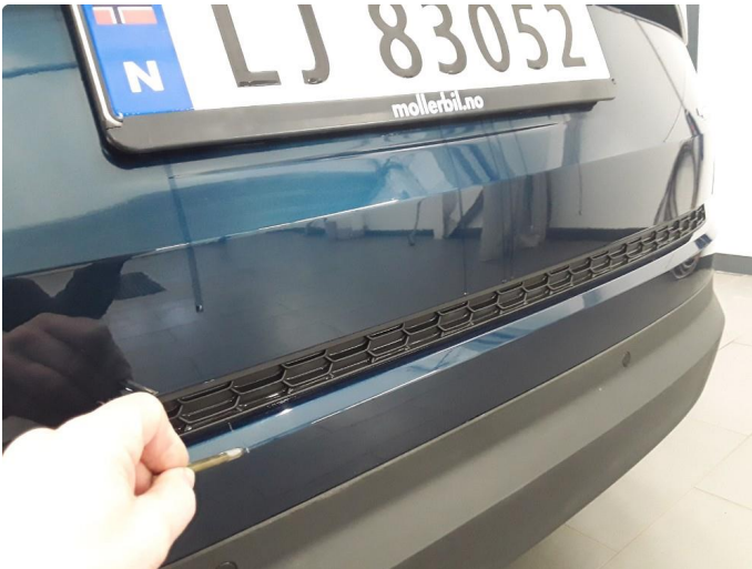
1.2 En liten innlastningsripe på støtfanger bak. Normal bruksslitasje
