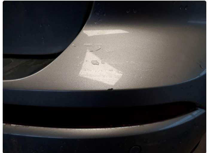
1.2 Ripe(r) ned til grunning
