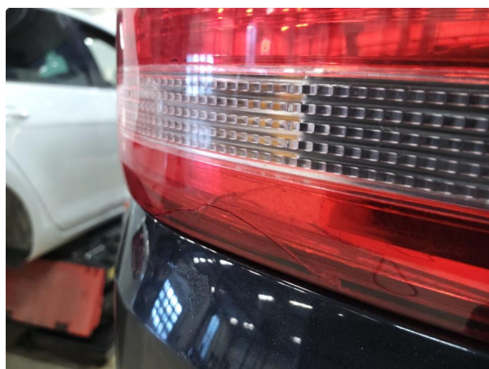
2.1 Defekt / sprukket glass
