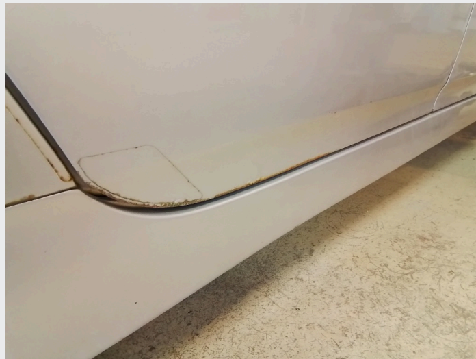
2.5 Begynnende rust nedre kant høyre bakdør.
