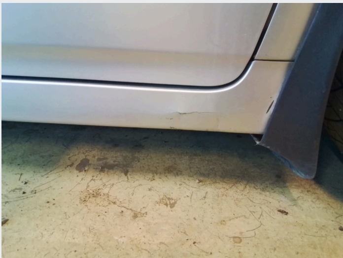
2.4 Skadet sideskjørt høyre
