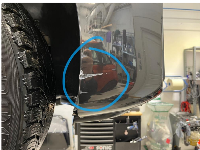
1.3 Liten rift på støtfanger høyre foran.
