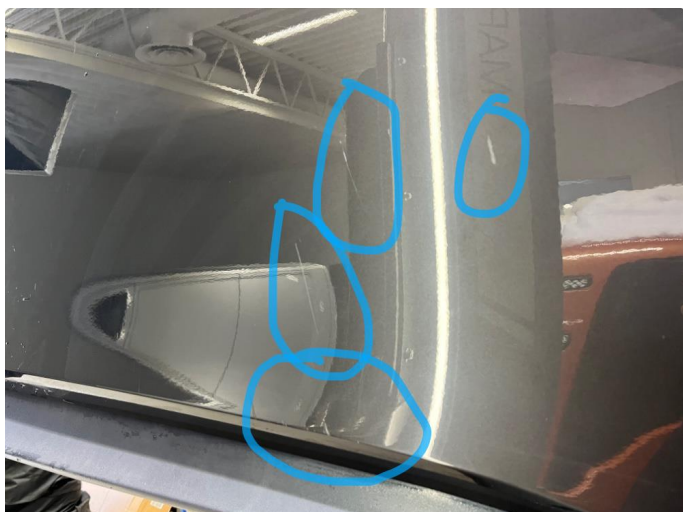
1.1 Noe riper på dør høyre foran
