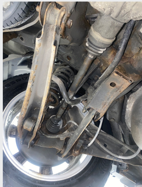
8.4 Svetting høyre bak mellom diff og aksling
