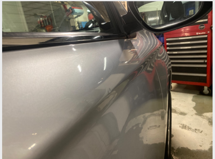
2.5 Liten bulk på profil, passasjerdør, anses som normal bruks slittasje
