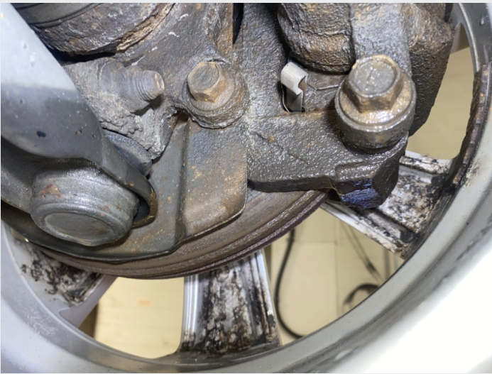
9.7 Skiver foran 23,7mm, påbegynnende rust
