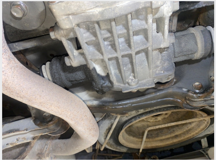
8.4 Svetting høyre bak mellom diff og aksling
