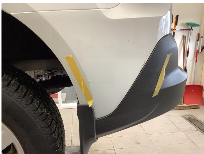
1.2 Noe riper støtfangervinge v.bak.
