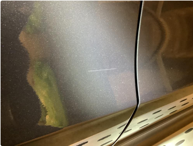
1.1 Ripe ned til grunning
