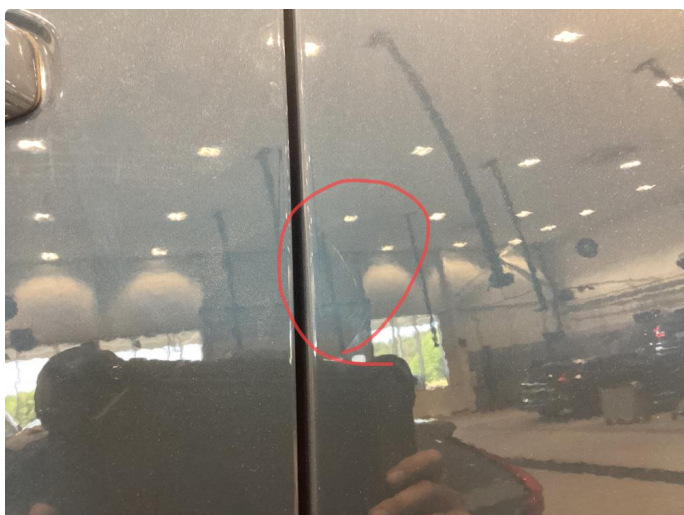
1.2 Ripper - poleres vekk
