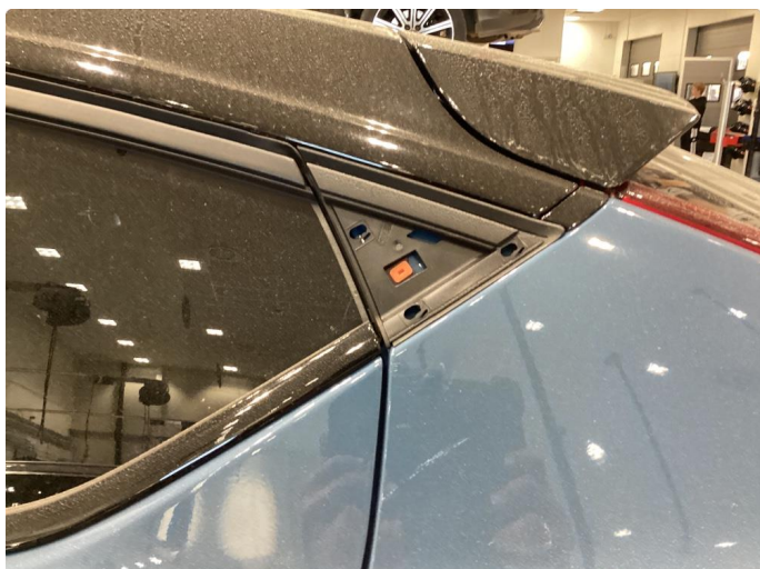
1.1 Løse/skadede lister - byttes på garanti
