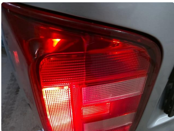
3.1 Defekt / sprukket glass. Utbedring er bestilt.
