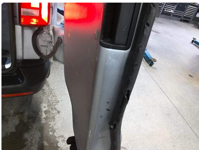
2.2 Pakning skadet. utbedres ikke.
