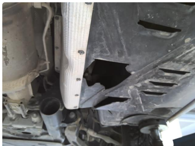
2.1 Beskyttelsesplate skadet. Utbedring bestilt.
