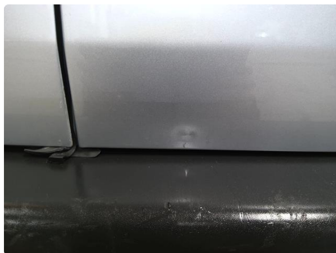
2.3 Bulk med lakkskade. Utbedres ikke.
