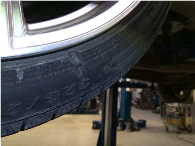
1.1 Dekkskade vinterhjul. Byttet
