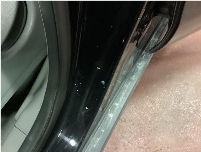
1.1 Liten bulk og merker i innsteg. Høyre side foran
