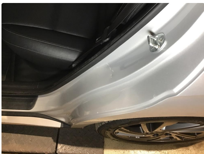
1.6 Bulk(er) med lakkskade
