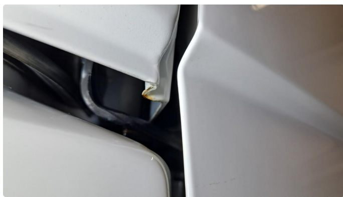
1.5 Rust i framkant av skinnedeksler.
