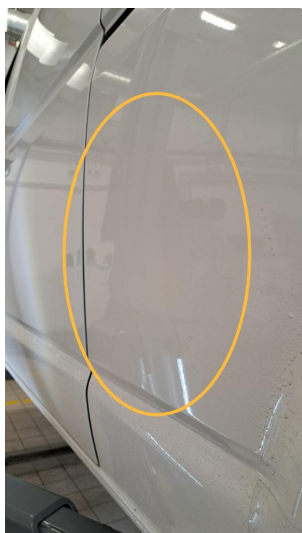
1.3 Bulker og påbegynt rust etter gnissing fra skinnedeksel.
