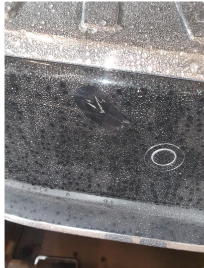
2.10 Ripe(r) ned til grunning
