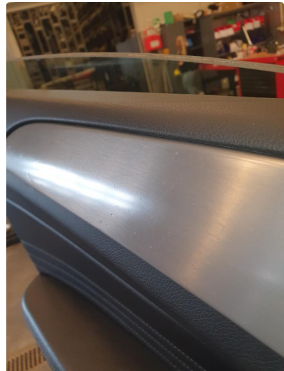
4.1 Skadet/merker etter utstyr
