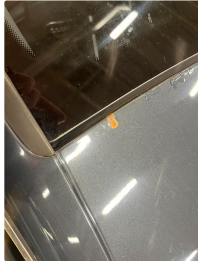
1.3 Steinsprut med rust/Blir flekket i
