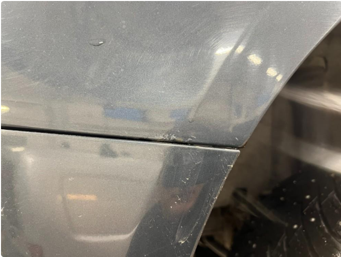
1.1 Litt rust mot støtfanger/Blir flekket i
