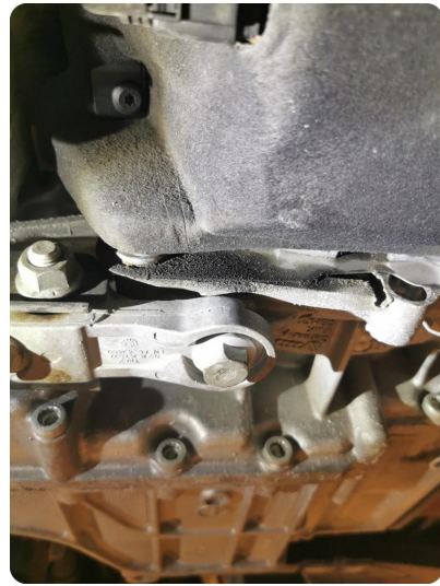
2.1 Oljelekkasje mellom motor/gear Lekasje mellom motor og girkasse
