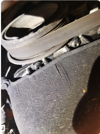
2.2 Oljelekkasje i forkant Lekasje tetteflens ved register
