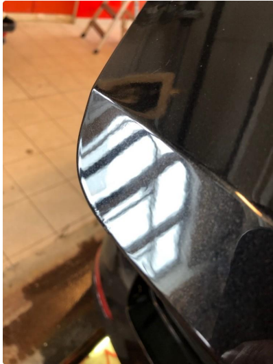
1.2 Lakksår øvre og nedre del av bakluke.
