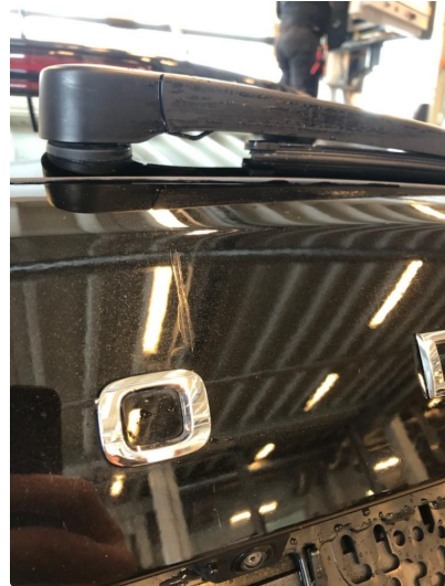
1.2 Lakksår øvre og nedre del av bakluke.
