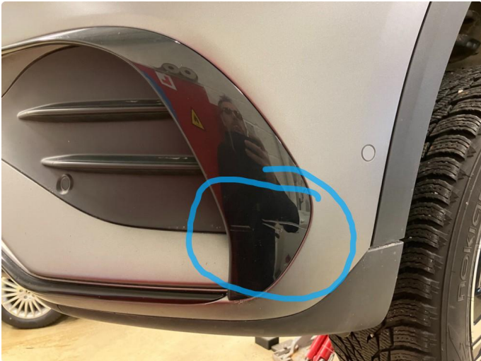
1.1 Ripe(r) ned til grunning
