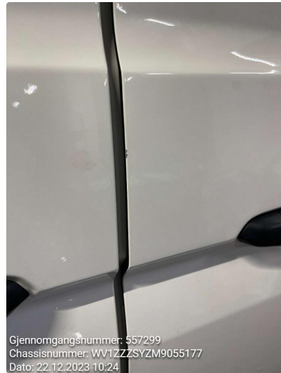
1.1 Små lakk skader på kanten av begge for dører. normalt ihht alder og bruk.
