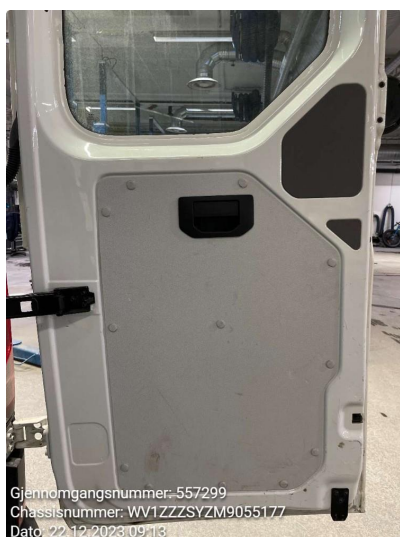
4.2 Riper døråpning. Normal slitasje. Blir ikke utbedret.
