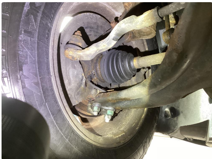
2.1 Löse drivaksel mansjetter begge sider
