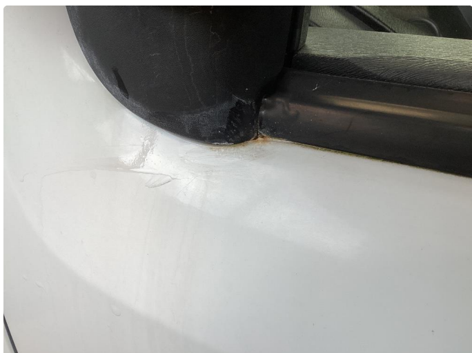
1.1 Noe rust under speil venstre fordør
