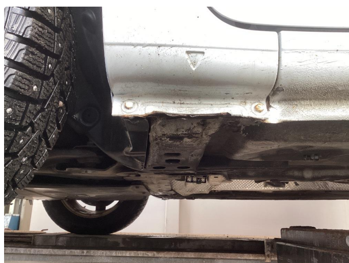
1.3 Noe merker i kanaler etter jekk
