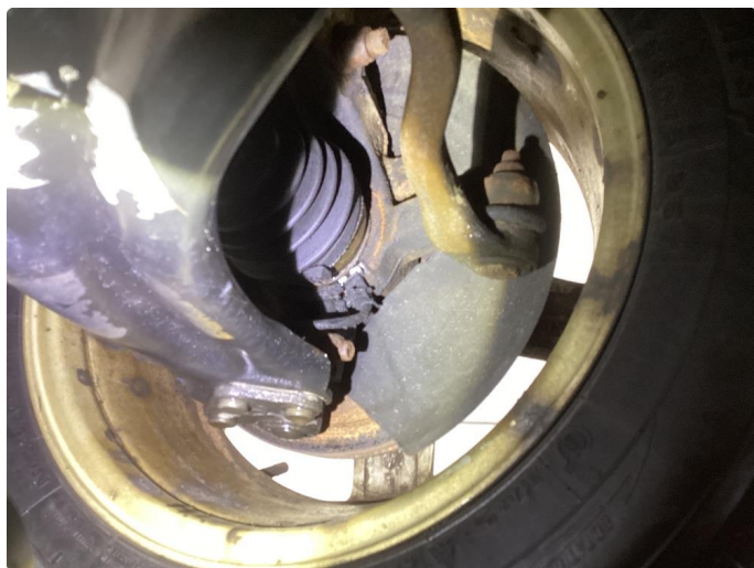
2.1 Löse drivaksel mansjetter begge sider
