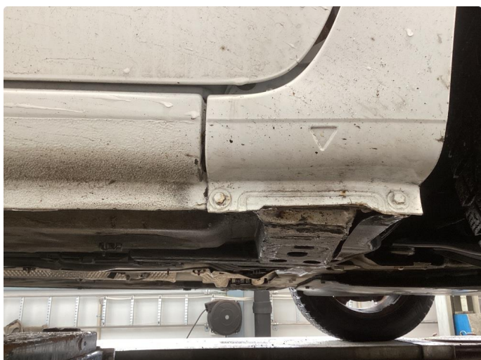
1.3 Noe merker i kanaler etter jekk
