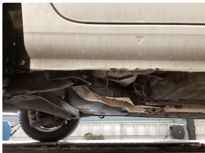
1.3 Noe merker i kanaler etter jekk
