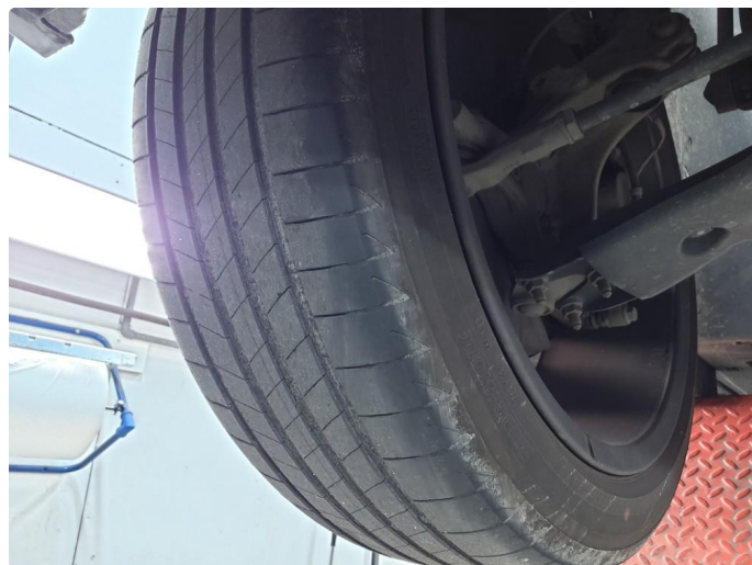
1.5 Skjev slitasje på sommerdekk
