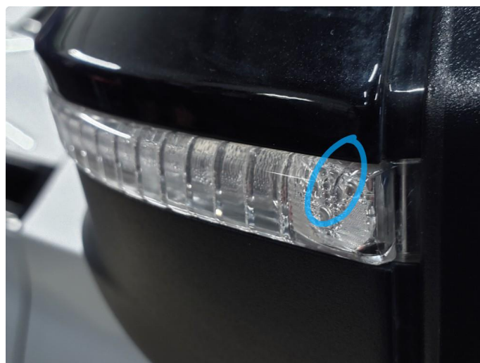
2.3 Krakelering i plast
