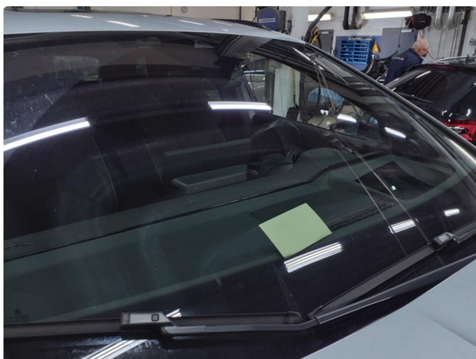
1.7 Steinsprut med sprekk
