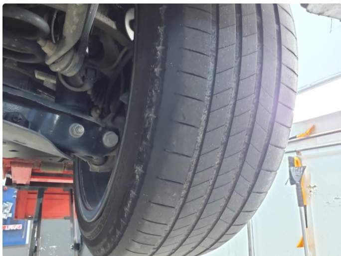
1.5 Skjev slitasje på sommerdekk
