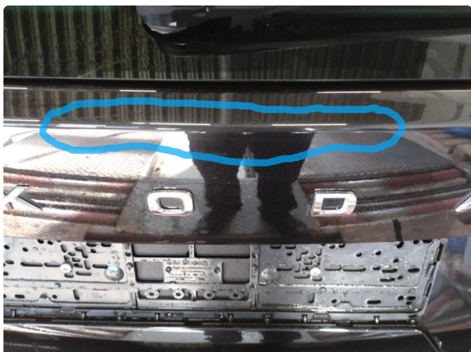
1.1 Ripe(r) ned til grunning
