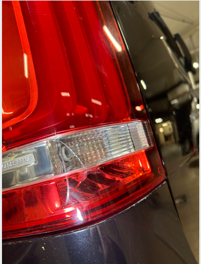
3.2 Sprekk i baklykt høyre og venstre side
