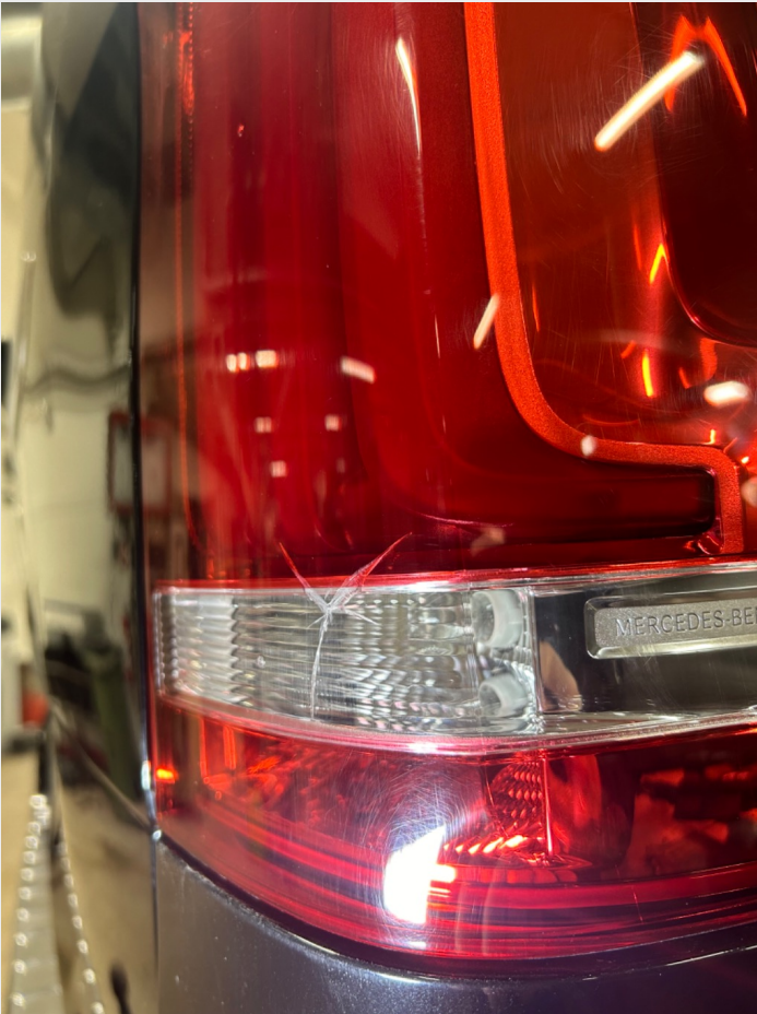
3.2 Sprekk i baklykt høyre og venstre side
