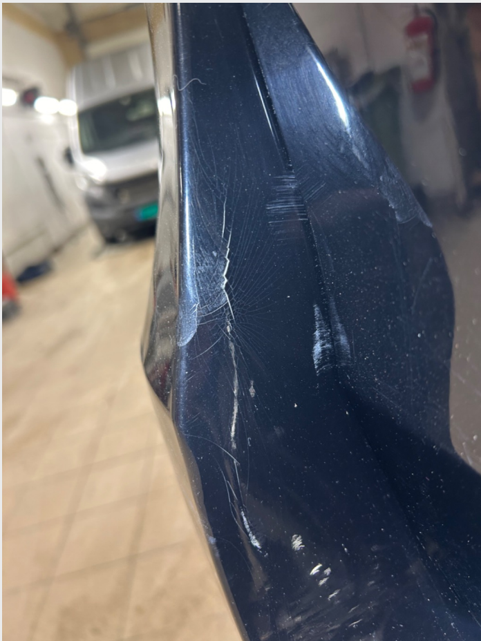
2.8 Sprekk i bakfanger venstre side
