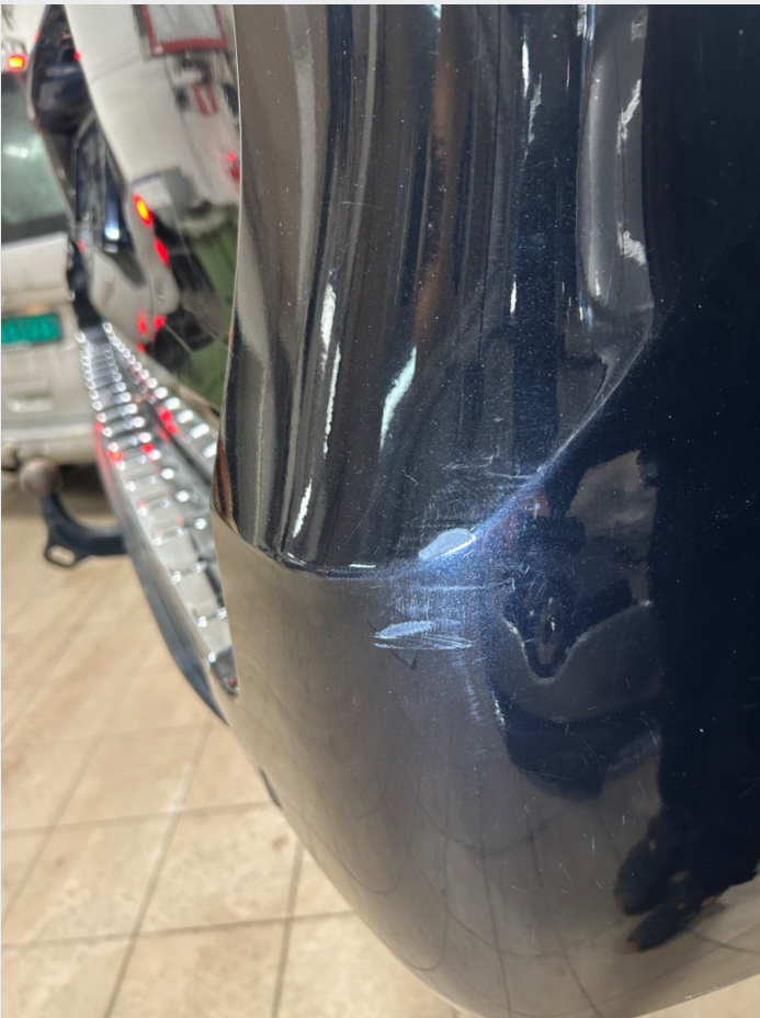
2.8 Skade/dype riper i bakfanger høyre og venstre hjørne
