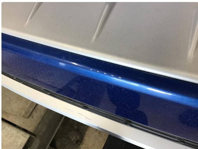
1.6 Ripe(r) ned til grunning
