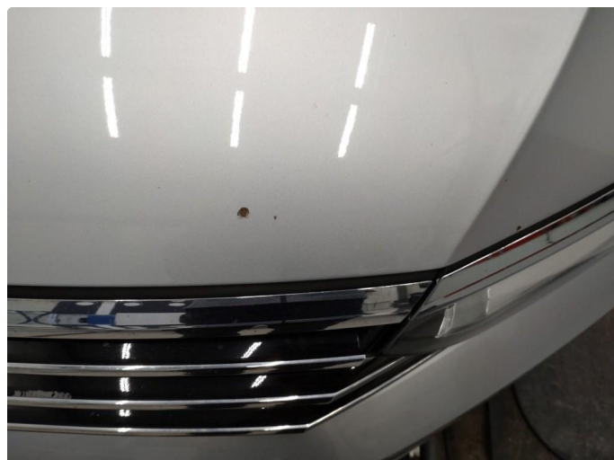
1.1 Noe steinsprut med rust - Flekket
