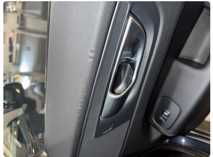
3.1 Skadet/merker etter utstyr
