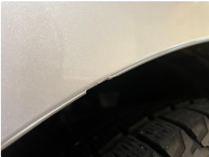
1.1 Steinsprut med rust - penslet
