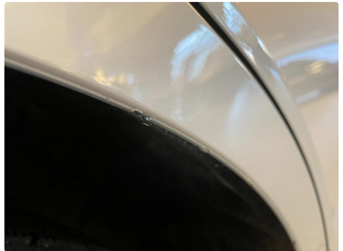
1.1 Steinsprut med rust - penslet
