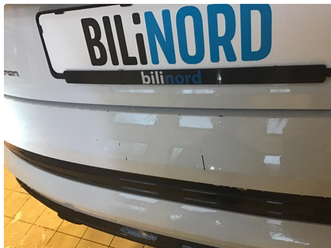
1.2 Ripe(r) ned til grunning
