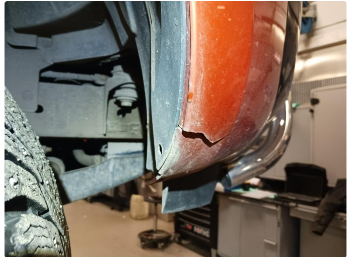
1.2 Sprekk og lakkskade framfanger.
