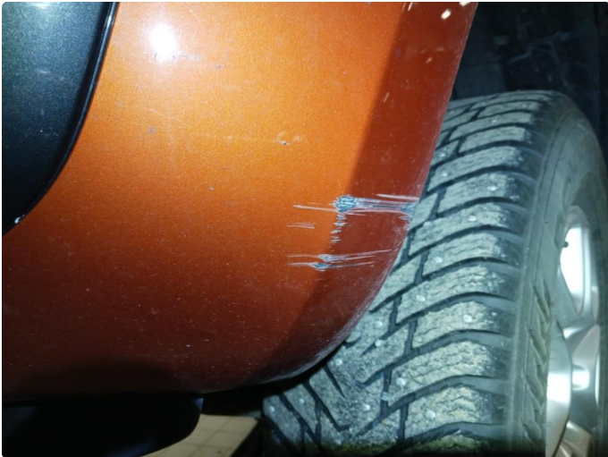
1.2 Sprekk og lakkskade framfanger.
