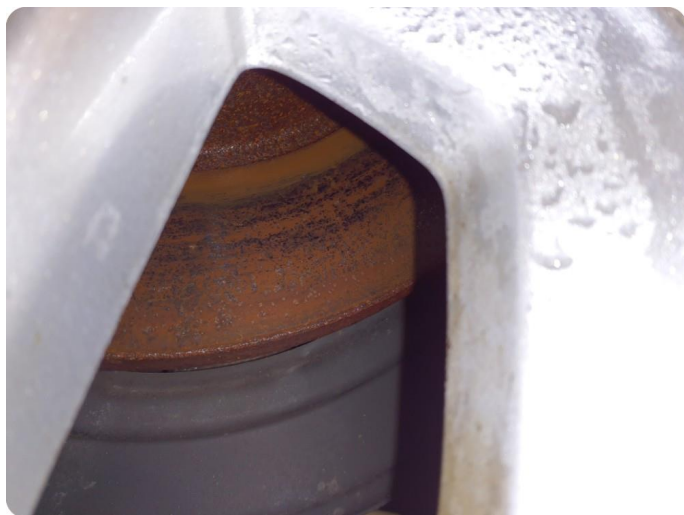
4.1 Mer enn 25% rust Tillegg løs abs ledning h.foran
