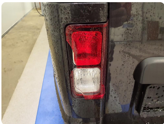
3.1 Defekt / sprukket glass
