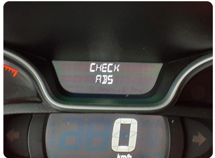
1.1 Varsellampe lyser se bilde Må kontrolleres
