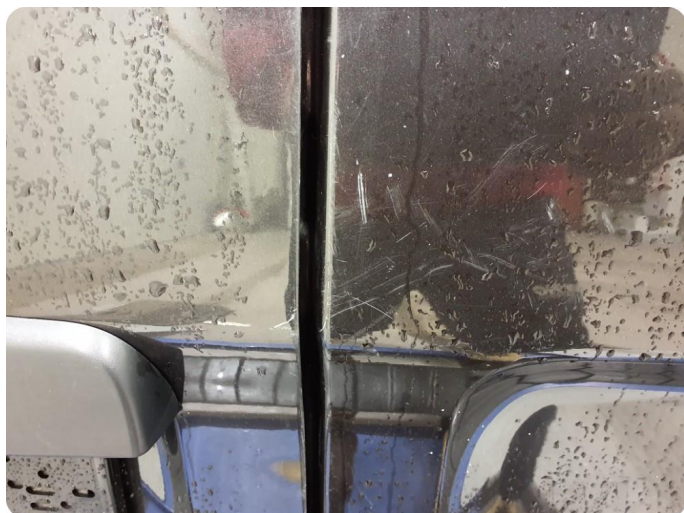
2.4 Ripe(r) ned til grunning
