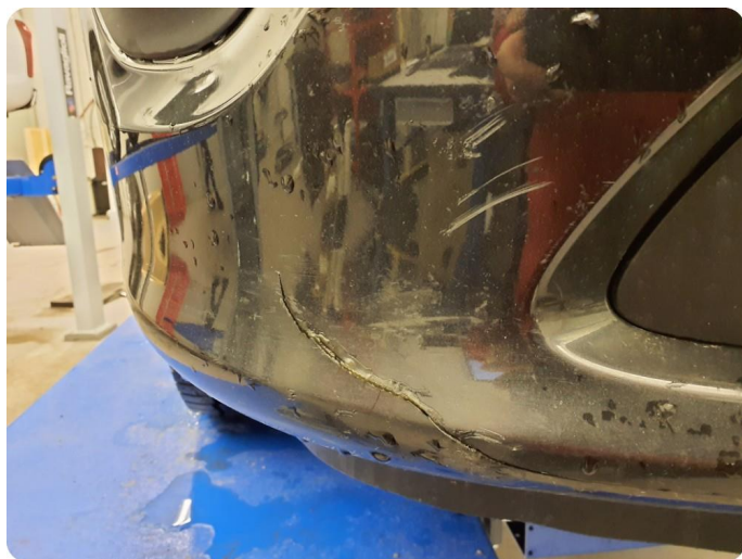
2.7 Skade Tillegg riper
