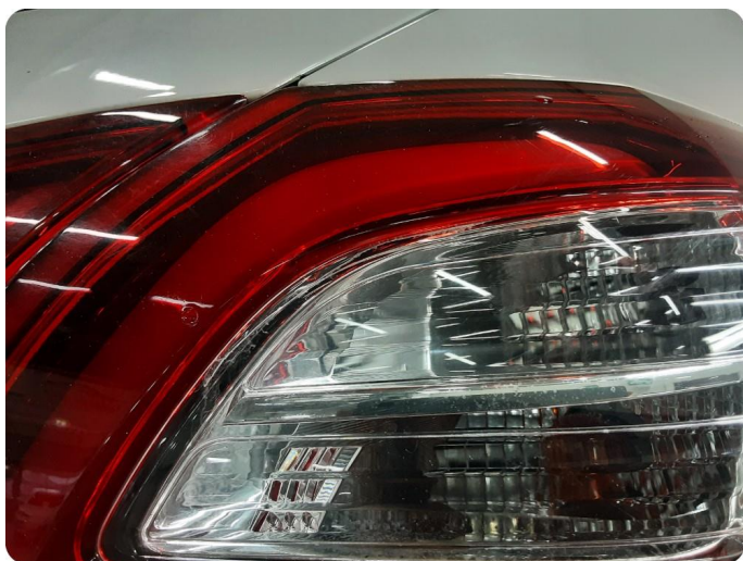
3.1 Krakelering i plast
