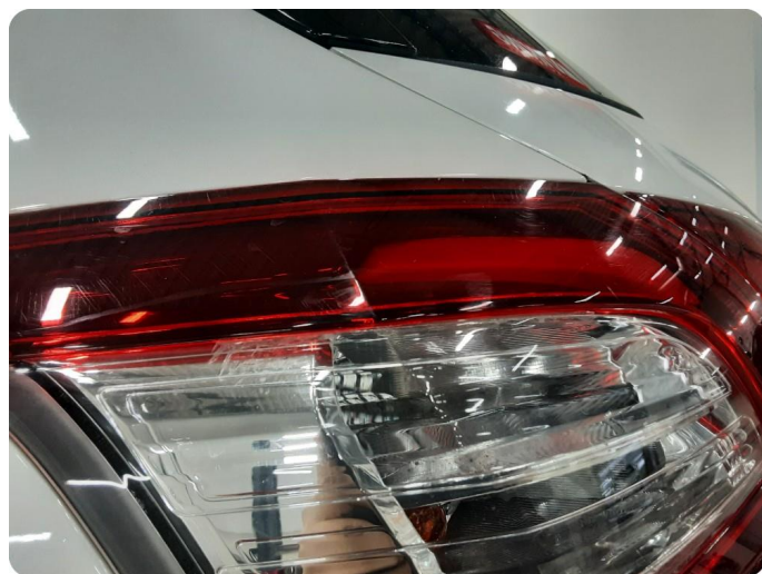
3.1 Krakelering i plast
