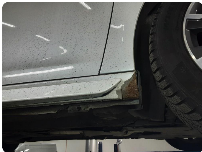
2.17 Bulk med lakkskade Bulk med lakkskade og rust
