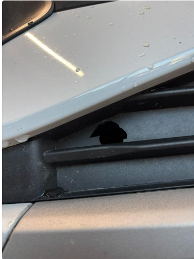
1.1 Lite hull i nedre del av frontfanger h.side. Lite synlig (Notert)
