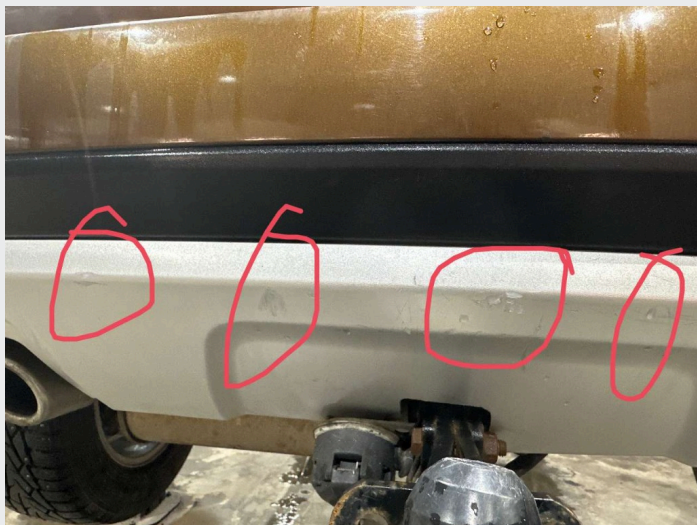
2.8 riper/lakkskade på støtfanger bak(vedlegg).
