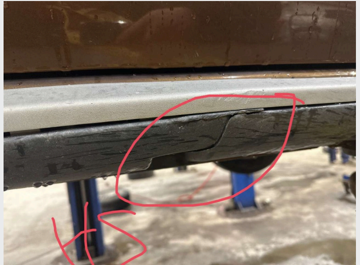
2.4 skade på kanalplast. (vedlegg)
