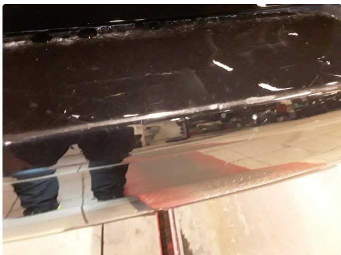
1.2 Noe riper og sår på støtfanger bak.
