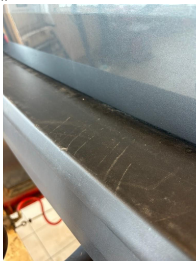
1.4 Noe riper øvre del av støtfanger bak.
