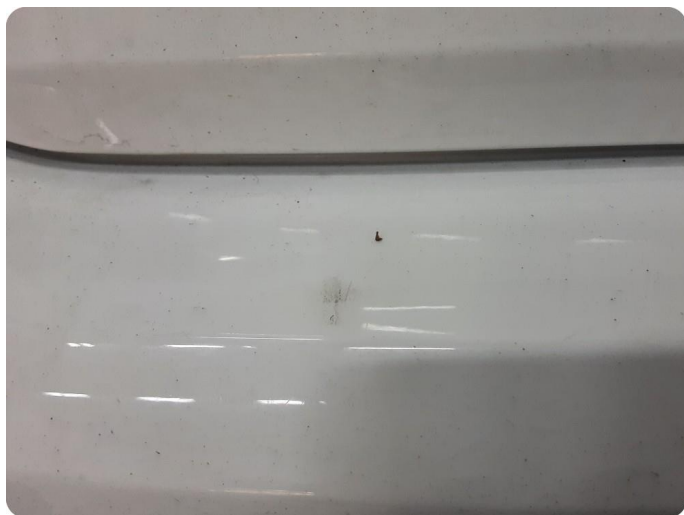
1.8 Ripe(r) ned til grunning
