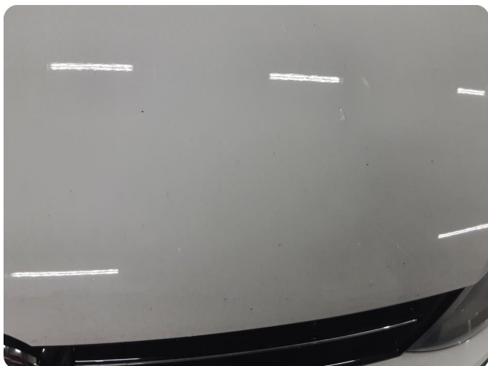
1.2 Noe steinsprut med rust
