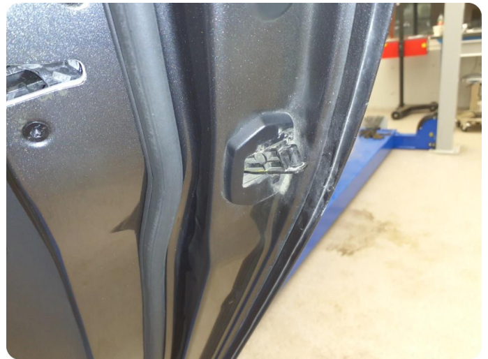
2.2 Øvrige feil Dørkant beskyttelse mangler
