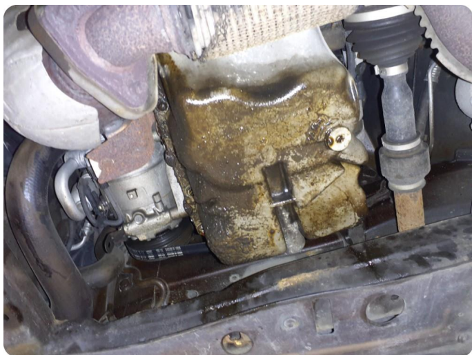
4.2 Oljelekkasje fra motor
