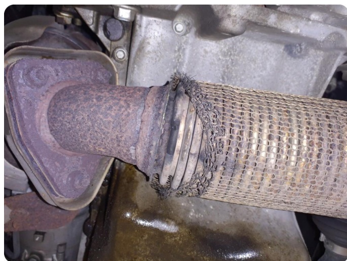
4.1 Skade på flexirør Eksoslekkasje.
