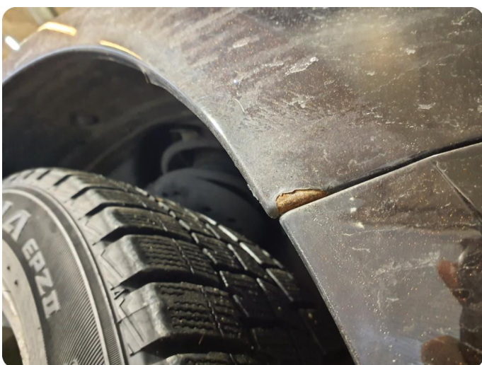
2.5 Steinsprut med rust
